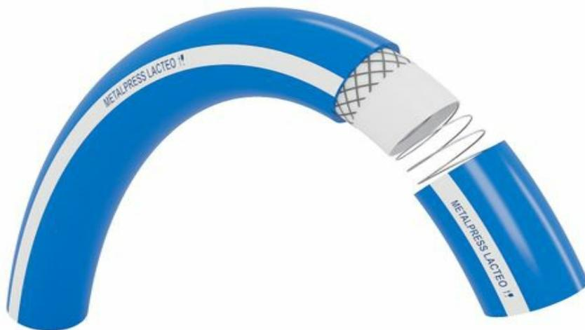
Manguera de caucho termoplástico (TPV) con doble refuerzo, textil y espiral metálica, para aspiración y trasvase de líquidos alimentarios grasos especialmente indicada para lácteos. Esterilizable a 90 °C.
