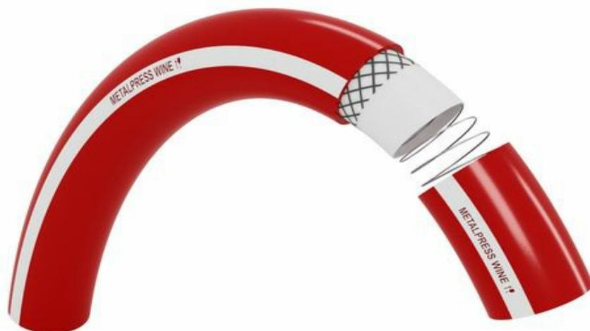
Manguera de PVC sin ftalatos con doble refuerzo, textil y espiral metálica, para aspiración y trasvase de líquidos alimentarios y alcohólicos a 50 °, así como lácteos. Especialmente indicada para aspiración e impulsión de mostos, vinos, cervezas y licores. Disponible versión con resistencia hasta 90 °C.
