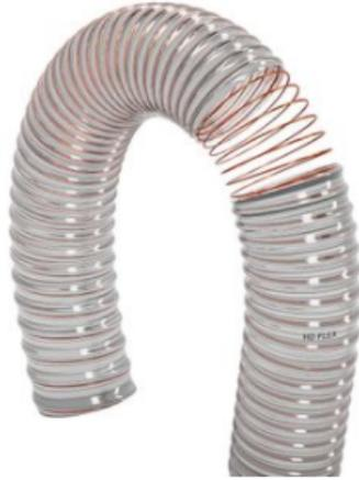
Tubería fabricada con poliuretano flexible y transparente, base poliéter y espiral interna de acero cobreado con carácter antiestático apta para instalaciones regidas por normativa ATEX, para la aspiración de productos con abrasión muy alta
