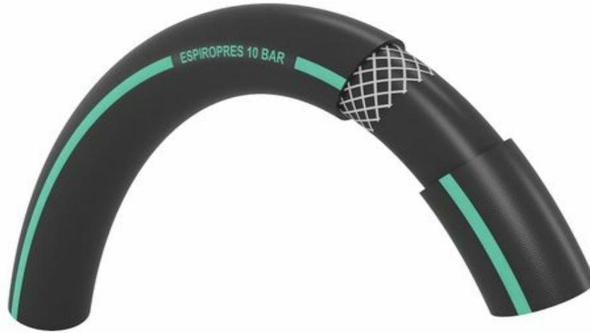
Manguera multicapa de PVC plastificado, reforzada con malla de poliéster, especial para equipos de aire comprimido a presiones medias
